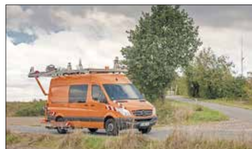
Messfahrzeug zur Erfassung von Ebenheit und Substanzmerkmalen
