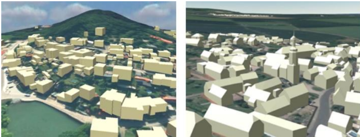
Abb. 53 LOD1-Modelle links und LOD2-Modelle rechts 26
