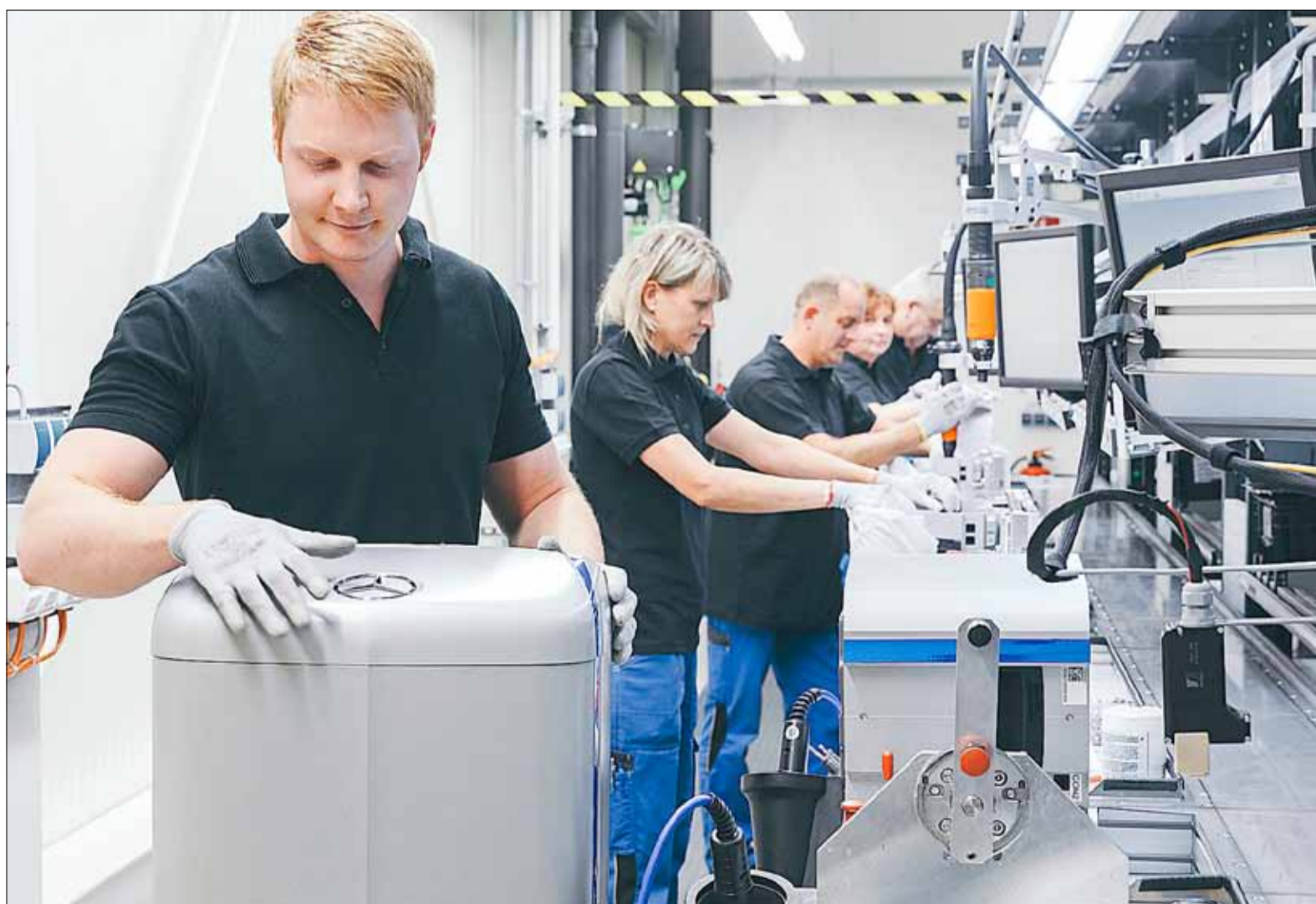
Serienproduktion der Mercedes-Benz Energiespeicher bei der ACCUMOTIVE im sächsischen Kamenz
