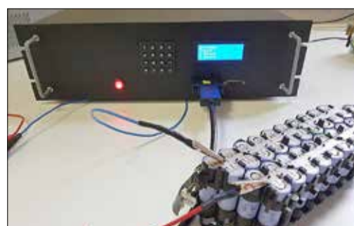
Bild von Zellpaket an unserem Entlader: Der Prototyp ist bereits ein Resultat aus EuBatIn.
